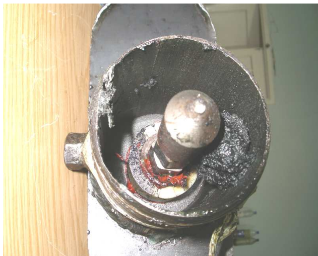
Рис. 12. Фото разобранного сосуда-реактора, где виден сгусток черного цвета между электродом и стенкой сосуда.
