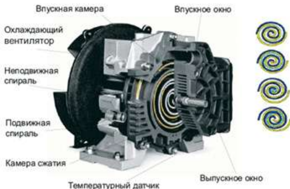
25-сурет. Сорғалап ағатын компрессордың құрамы.
