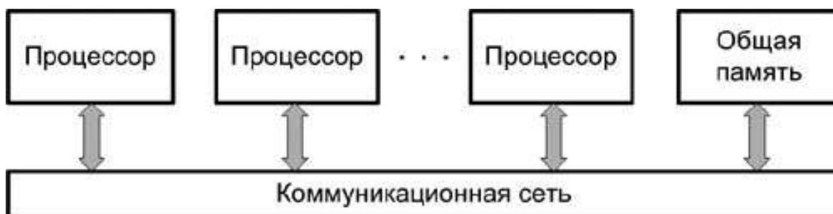
Рис. 3. Структура вычислительной системы с общей памятью
