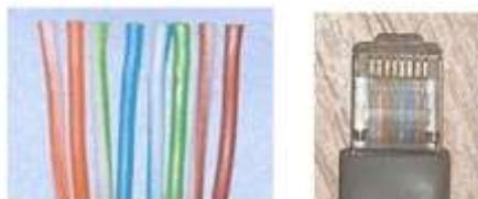
Рисунок 4.4. Порядок расположения проводников по стандарту TIA/EIA-568B
