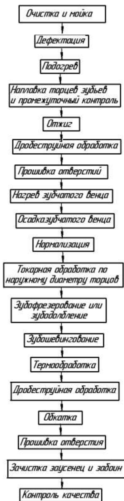
Рисунок 7. Схема технологического процесса восстановления зубчатых колес.
