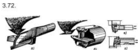
28-сурет. Кесу құралына орнатылған шаң-қиқым қабылдағыш: а – қашаудың саңлаулы сорғышы, б,в,г – қашап өңдеу жұмысына арналған шаң-қиқым қабылдағыш
