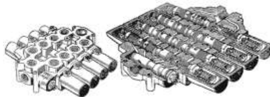
Рисунок 5.6 Общий вид (а) и продольный разрез (б) моноблочного четырехзолотникового гидрораспределителя
