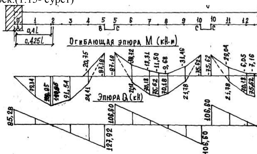
8-сурет. Қосалқы арқалықтағы M және Q жүктемелерінің эпюралары.
