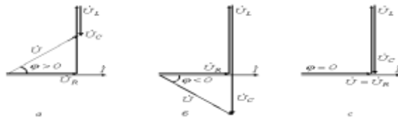
2.18 - Сурет Реактив элементтері тізбектей жалғанған айнымалы тоқ тізбегінің векторлық диаграммалары: а) резонансқа дейін U_L > U_C ; б) резонансқа дейін U_C > U_L ; в) резонанс кезінде U=U_R U_L=U_C
