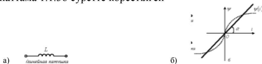
Сурет 1.3 а) индуктивті ораманың шартты белгісі б) индуктивті ораманың вебер амперлік сипаттамасы
