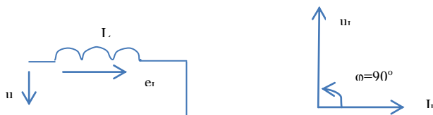
2.6 Сурет - Идеал индуктивті элемент: қосылу сұлбасы(а); векторлық диаграммасы(в).
