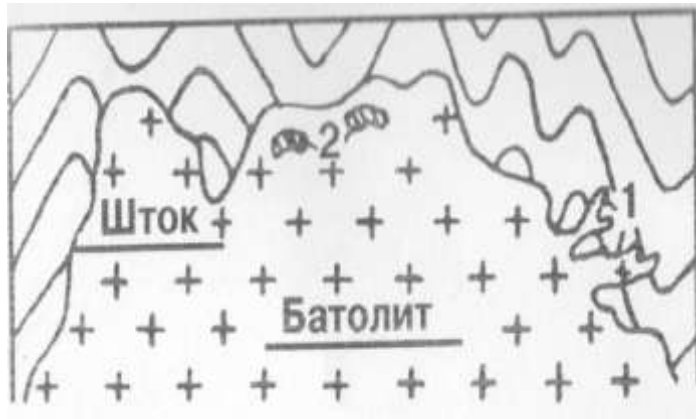
сурет 1 Батолит пен шток. 1. апофиздер; 2. Ксенолиттер
