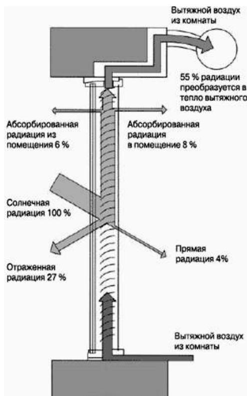
Рис. 1. Схема распределения теплоступлений от солнечной радиации через вентилируемое окно
